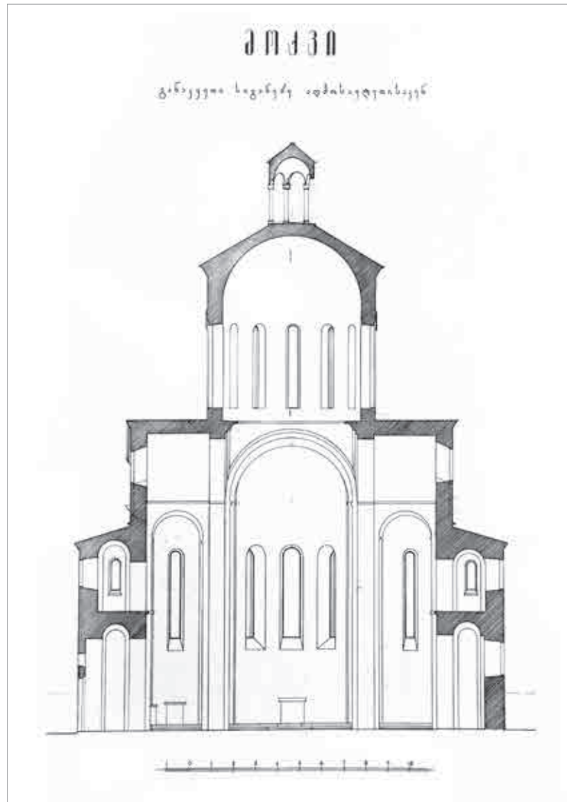
ღვთისმშობლის სახელობის გუმბათიანი ტაძარი X ს. მოქვი. განაკვეთი სიგანეზე აღმოსავლეთისკენ ნახაზი ვ.წილოსანისა და თ.თოდუასი. 1948 წ. ქალღმერთი, გუმბ. 84X60 სმ (საბ. სმ)
